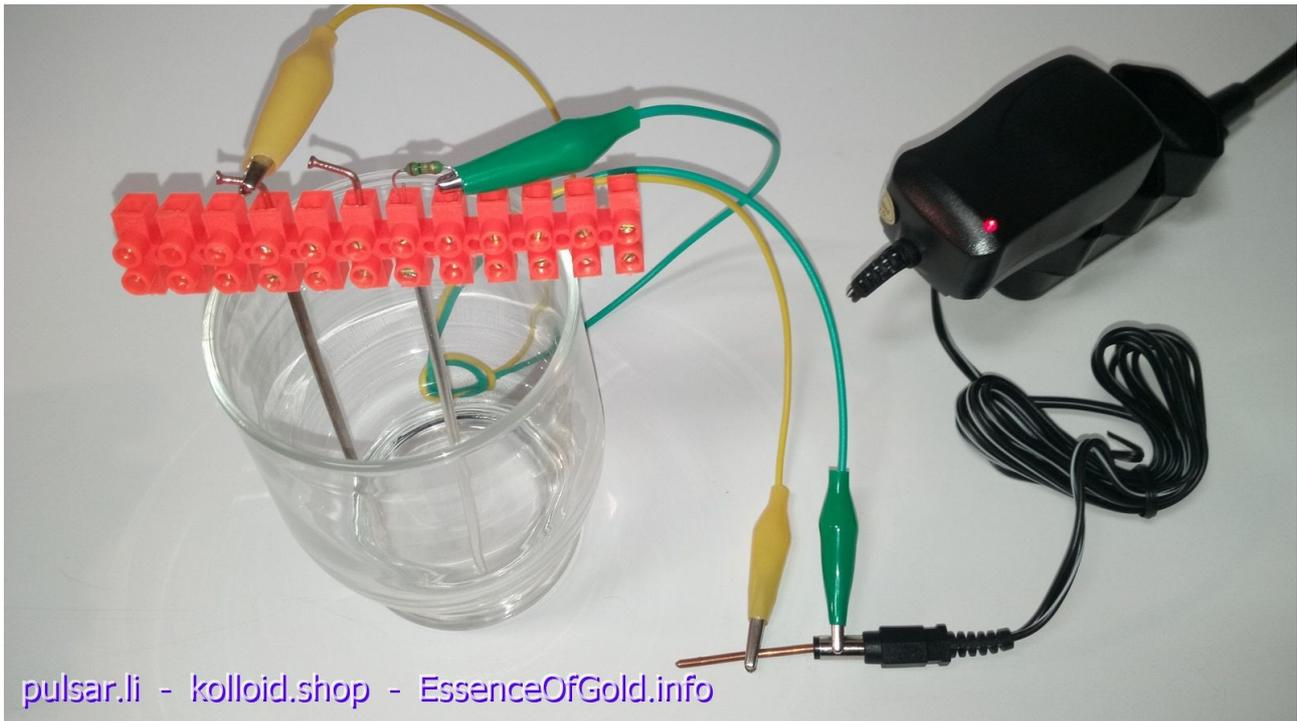
Beim Steckkopf des 24V Adapters den mitgelieferten kurzen Kupferstab reinstecken, um **den (plus) Strom** der Innenwand des Kopfes abnehmen zu können.
